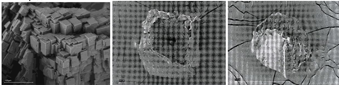
Рис. 1. Поликристаллический агрегат кубиков графита (слева) и кубические кристаллы графита с повреждёнными вершиной и гранями кубических «футляров», которые вскрыли внутренний структурированный графитовый наполнитель (в центре и справа).
